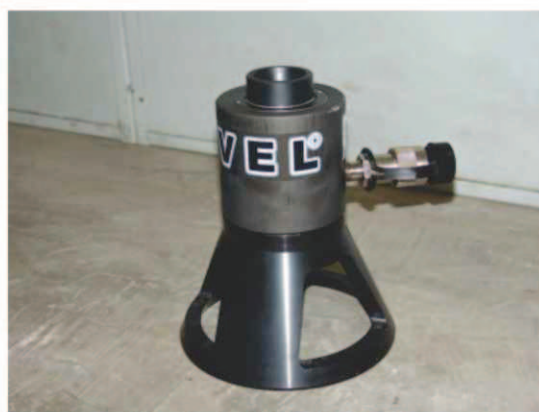
Exemplo de TRCHA-121 especial adaptado para testes de resistência de carga.
